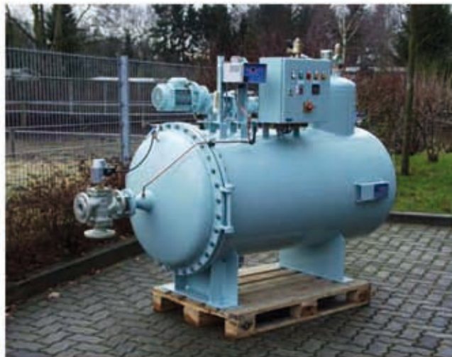
Bilgenwasserentöler MPEB gemäß MEPC 107 (49), Design und Abmessungen wie PPT-BWS Serie.
