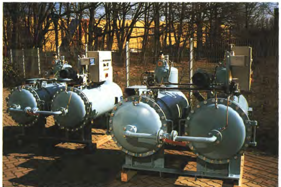
Zwei Entöler 2000 für die bei Kvaerner-Masa Yards in Helsinki entstehenden Costa-Kreuzfahrtschiffe
