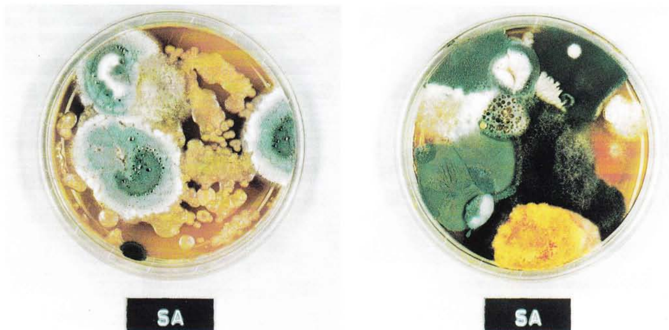
Abb. 1 und 2: Mikrobiologische Abstriche ungenügend entwässerter Dieselproben
